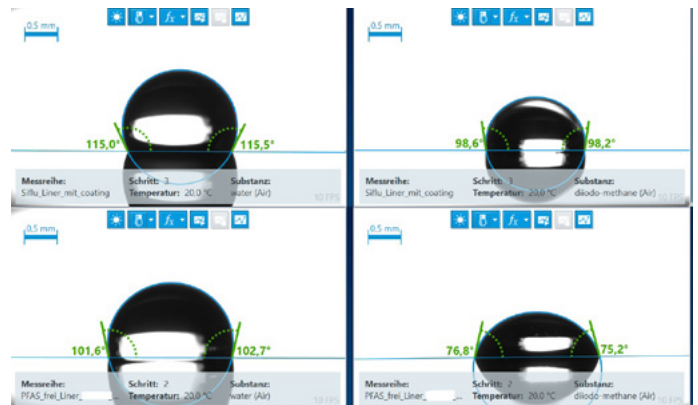
Abb. 2: Kontaktwinkelmessungen zeigen kleinere Benetzbarkeit des PFAS-haltigen Referenzliners gegenüber dem PFAS-freien Liner.
