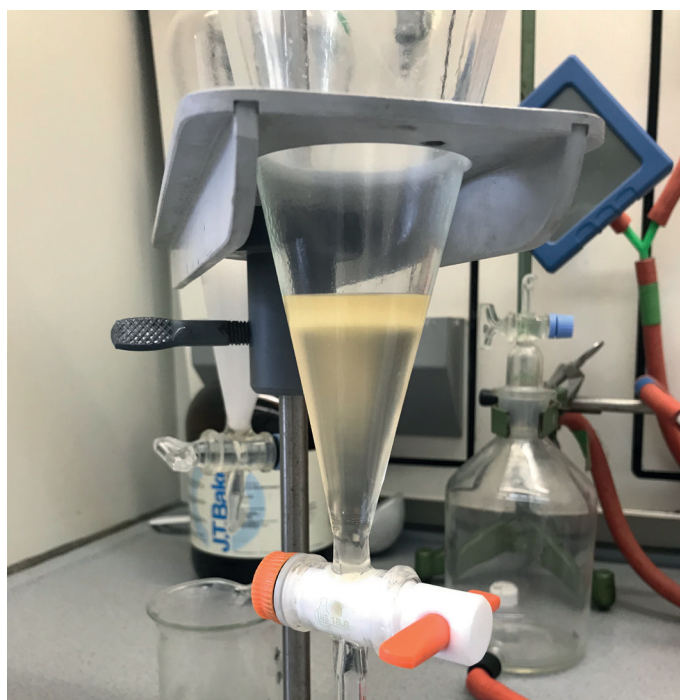
Abb. 2: Flüssig-Flüssig-Extraktion der wässrigen Seifenlösung (eigenes Foto)
