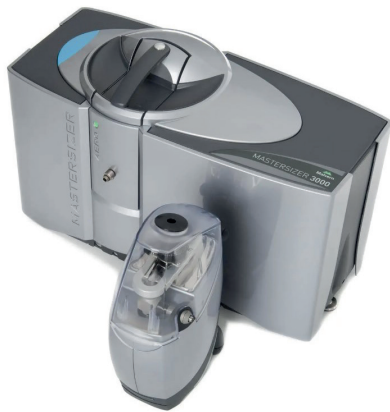
Abb. 1: Partikelgrößenmessgerät Mastersizer 3000 von der Firma Malvern. (Quelle: http://Mastersizer 3000/Weltweit branchenführendes Partikelgrößenmessgerät/Malvern Panalytical , 13.06.2021)
