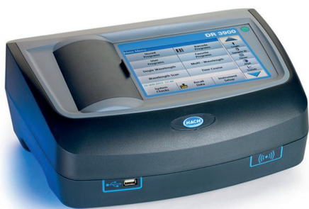
Abb. 1: Spektralphotometrische CSB Bestimmung Quelle: https://de.hach.com/dr3900-spektralphotometer-mit-rfid-technologie/product?id=23358295122&callback=qs#
