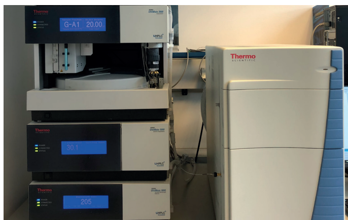
Abb. 1: HPLC-MS System (eigenes Foto)
