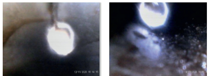
Abb. 2: Vergleich eines sauberen Reaktorrohres (links) mit einem durch Fouling-Prozesse stark verunreinigtem Rohr (rechts), (eigenes Foto)
