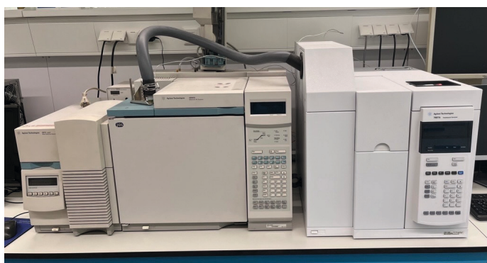
Abb. 1: Gaschromatograph mit Headspacesampler und Massenspektrometer
