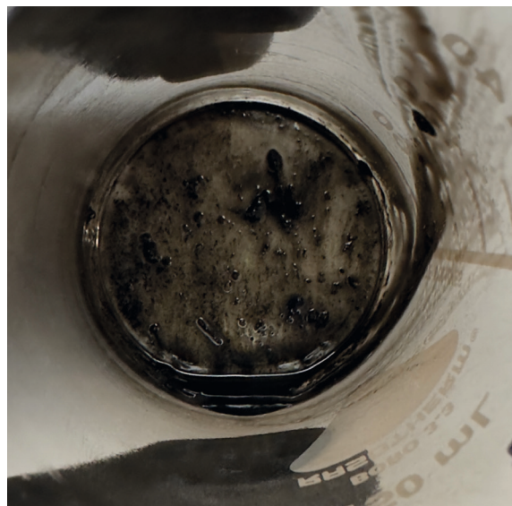
Abb. 2: Niederschlag einer Altölprobe.
