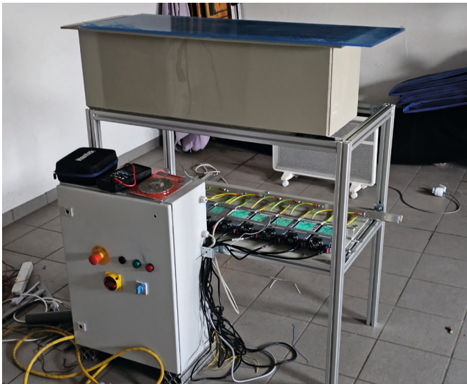
Abb. 1: Elektrolysetank mit Steuerung
