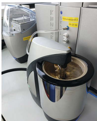
Abb. 1: Mastersizer 3000 in Nassmessungskonfiguration.
