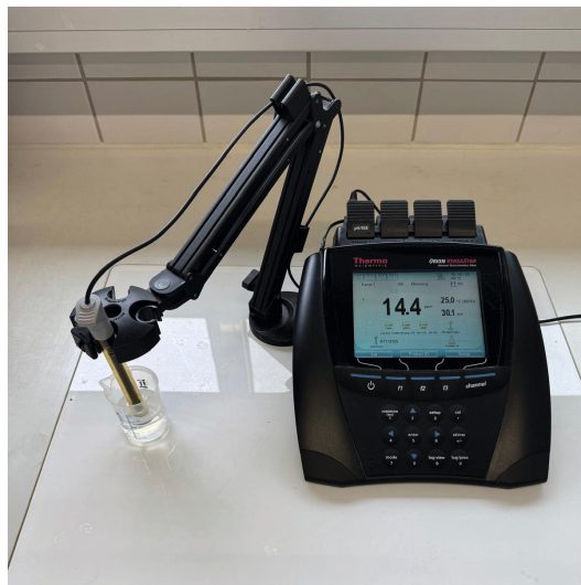
Abb. 2: Fluoridmessung mittels ionenselektiver Elektrode und Thermo Scientific Orion Versa Star Messgerät.
