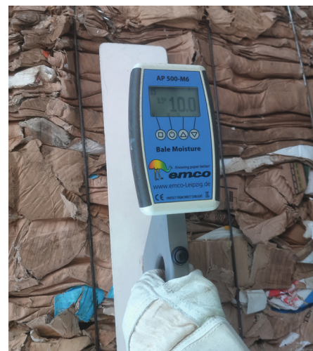
Abb. 2: Bestimmung des Wassergehalts mit dem Handmessgerät.
