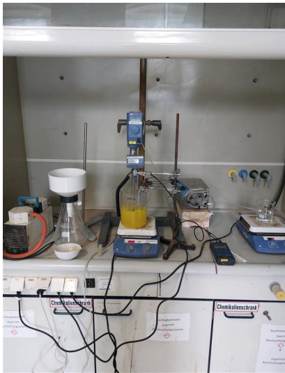
Abb. 1: Versuchsaufbau für Synthese von \text{YVO}_4
