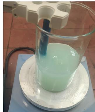
Abbildung 2: Fällung als Nickelhydroxid (eigenes Foto).
