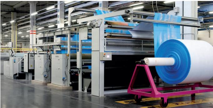
Abbildung 1: Spannrahmen in einer Textilausrüstung
