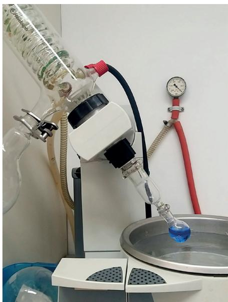
Abbildung 1: Entfernung von Lösungsmittel durch Rotationsverdampfer (eigenes Foto).
