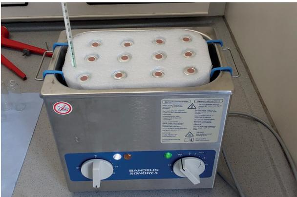
Abb. 1: Extraktionsvorgang der PAK aus dem Straßenstaub im Ultraschallbad
