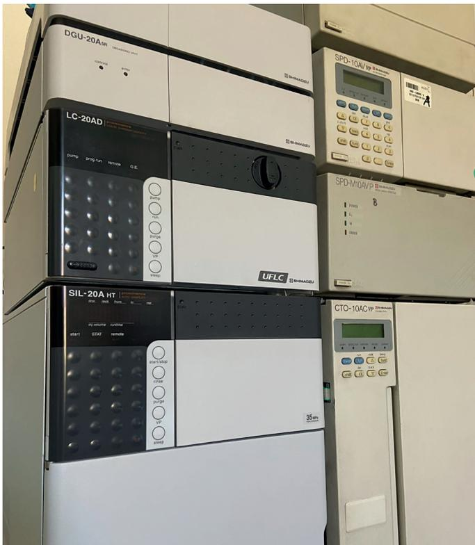
Abb. 1: HPLC-Gerät
