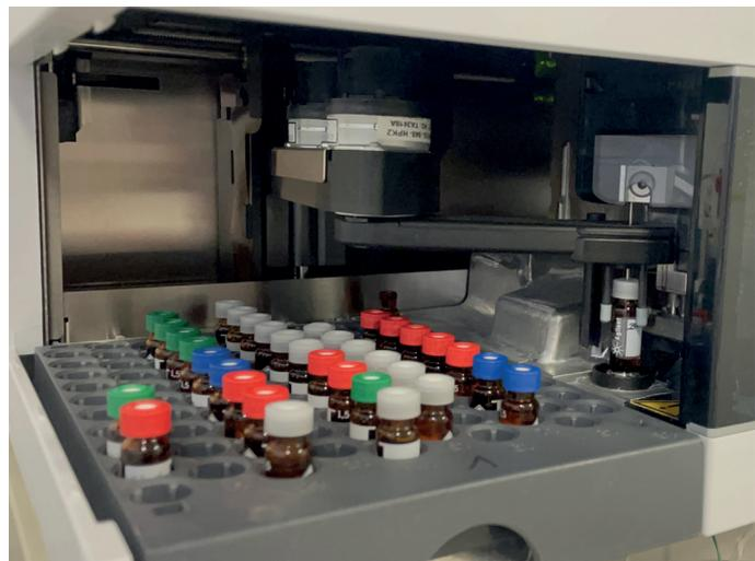
Abb. 2: Autosampler des älteren HPLC-Modells ohne Thermostat
