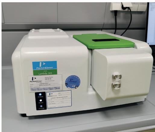
Abb. 1: UV/VIS Zweistrahlenspektrophotometer
