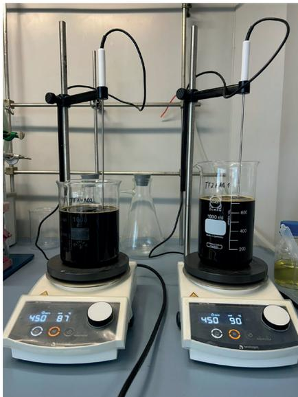
Abb. 1: Erwärmung des Reaktionsgemischs
