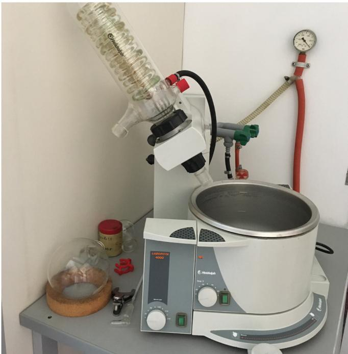
Abb. 1: Rotationsverdampfer (eigenes Foto)
