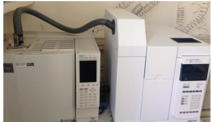
Abb. 2: Gaschromatograph Shimadzu GC-2010 und Agilent Technologies 7697A Headspacesampler (eigenes Foto)
