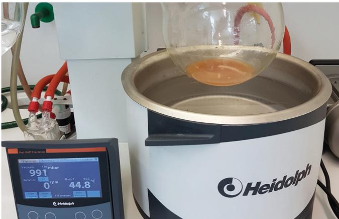
Abb. 1: Verdampfung des Lösungsmittels von Lignosulfonaten (eigenes Foto)
