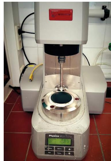
Abb. 2: Kegel/Platte Rheometer Physica MCR 101 von Anton Paar (eigenes Foto)
