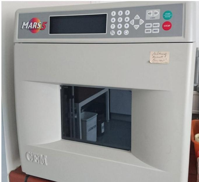
Abb. 1: Mikrowellen-Aufschlussgerät CEM MARS 5
