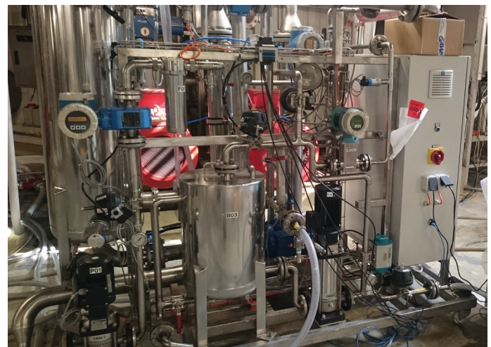
Abb. 2: Querstromultrafiltrationsanlage (eigenes Foto)
