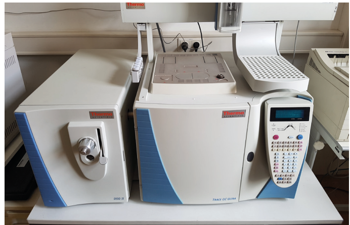
Abb. 2: Das zur Analyse verwendete GC-MS (GC: Thermo Scientific TRACE GC ULTRA; MS: DSO II) (eigenes Foto)
