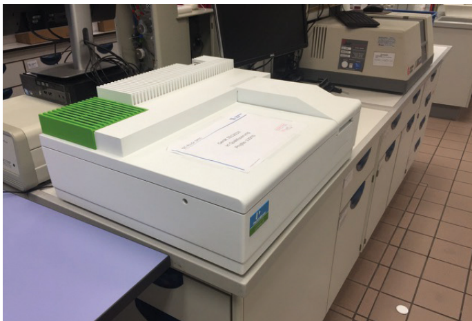
Abb. 1: Photometer Lambda 35 der Firma Perkin Elmer (im Hintergrund das Photometer Beckman Coulter DU 800) (eigenes Foto)
