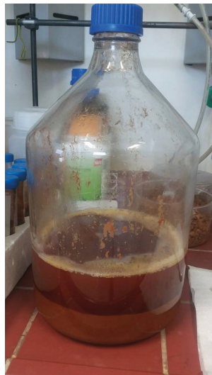
Abb. 1: Biomassepellets nach dem Säurekochen (eigenes Foto)
