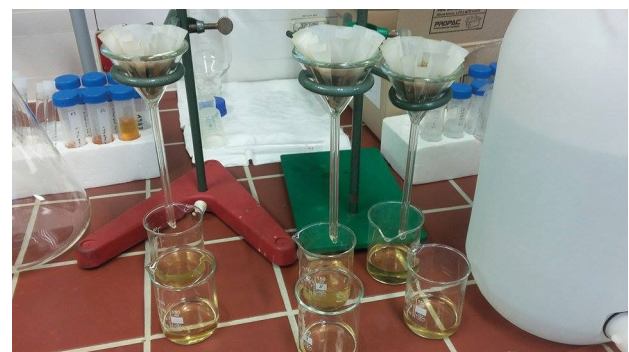
Abb. 2: Filtration nach ÖNORM L 1086-1 (eigenes Foto)
