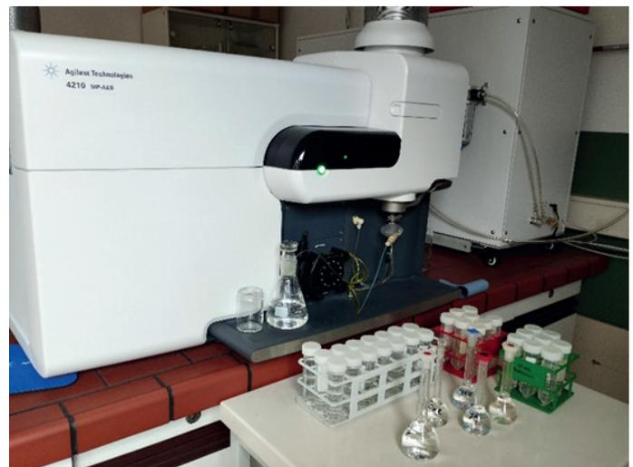
Abb. 2: Messung der Proben mittels MP-AES.
