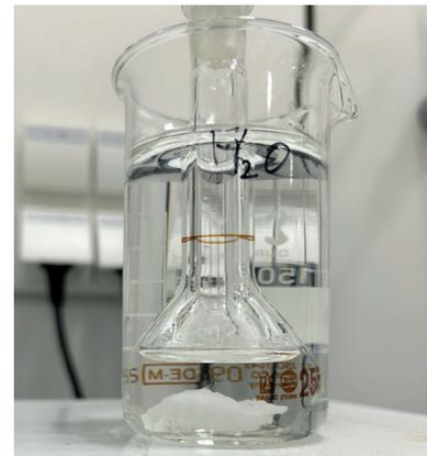
Abb. 2: Lösen mittels Wasserbads.
