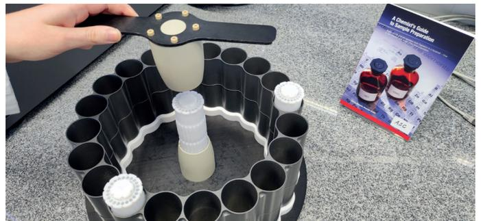
Abb. 2: Rotor 20SVT50 für Multiwave 5000.
