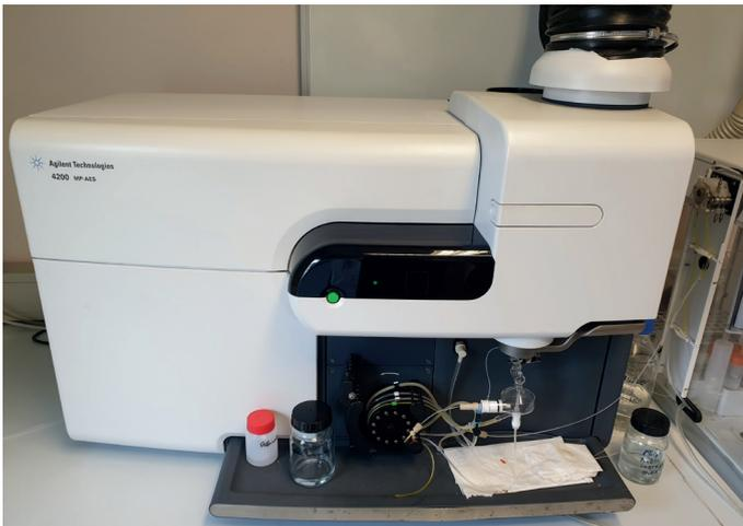
Abb. 1: MP-AES zur Schwermetallbestimmung.
