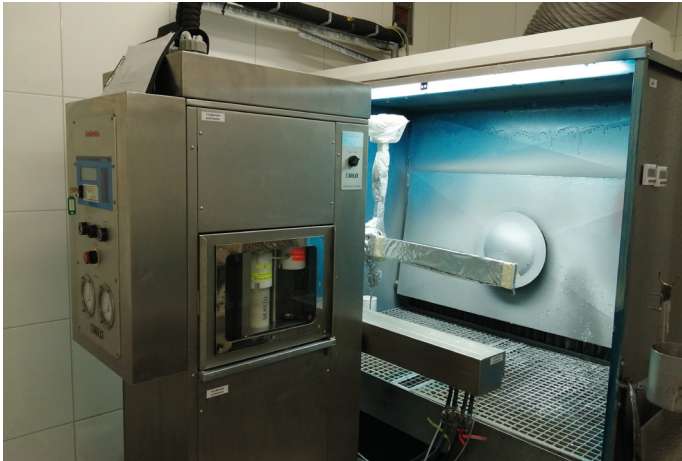
Abb. 1: Sprühroboter zur Applizierung von Lacken (eigenes Foto)
