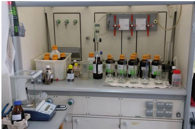
Abb. 1: Analysenwaage und Probeneinwaage (li.), Lösungsmittel mit Digital-Bürette (re.) (eigenes Foto)
