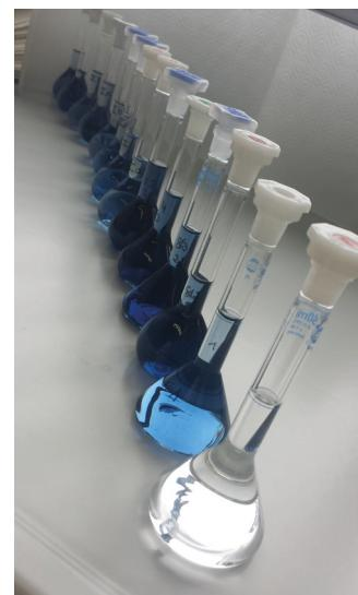
Abb. 2: Verdünnungsreihe für eine photometrische Messung mit Folin-Ciocalteu Reagenz (eigenes Foto)
