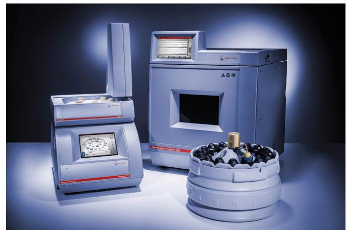
Abb. 2: Monowave 400 + Autosampler (links) und Multiwave PRO SOLV (rechts) (Anton Paar GmbH)
