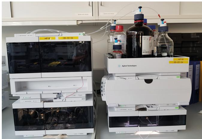
Abb. 1: Aufbau eines HPLC-Gerätes (eigenes Foto)
