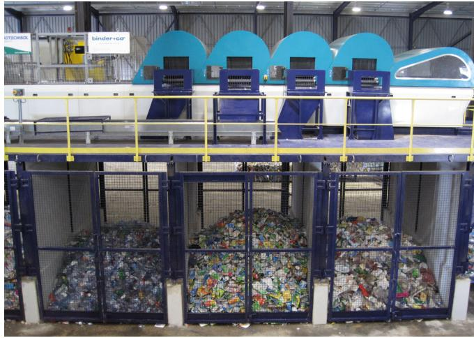
Abb. 1: Optische Sortiermaschine Clarity Multiway der Firma Binder+Co AG zur Sortierung von Verpackungsmüll (eigenes Foto)
