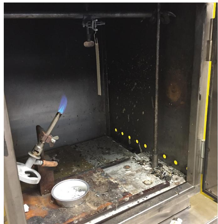
Abb. 2: Prüfaufbau zur Brandklassenbestimmung nach UL 94 (eigenes Foto)
