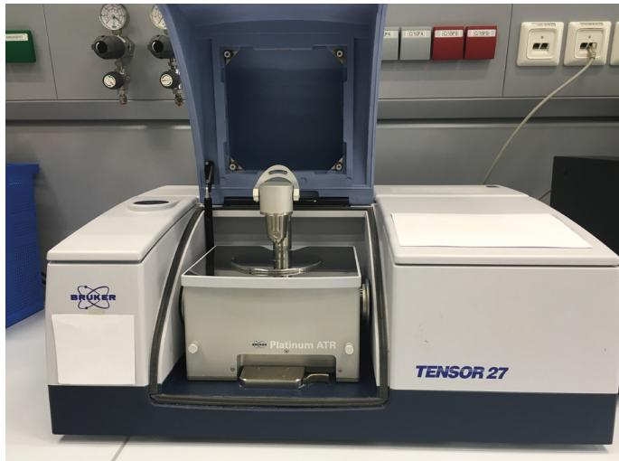
Abb. 1: IR-Spektrometer der Marke Bruker mit ATR-Einheit
