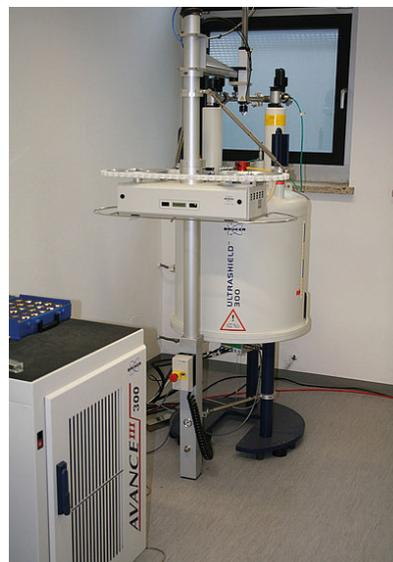
Abb. 2: Kernresonanzspektrometer
