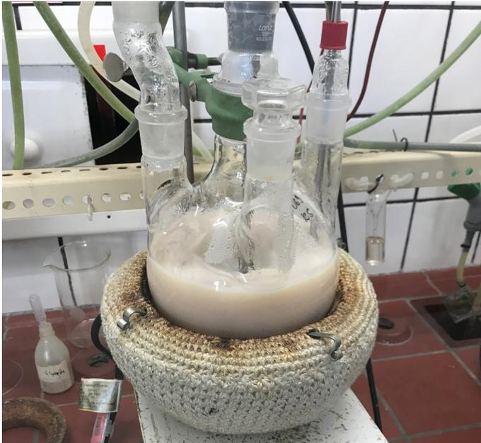
Abb. 1: Geräteaufbau bei der Herstellung von PU-Dispersionen (eigenes Foto)
