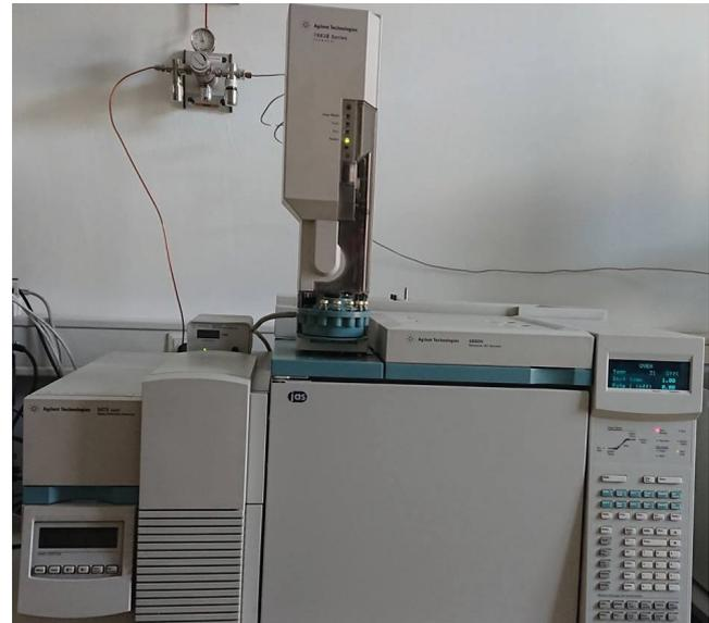
Abb. 2: Gaschromatograph mit Massenspektrometer (eigenes Foto)
