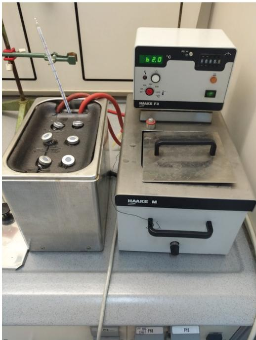
Abb. 1: Extraktion mittels Ultraschallbad (eigenes Foto)
