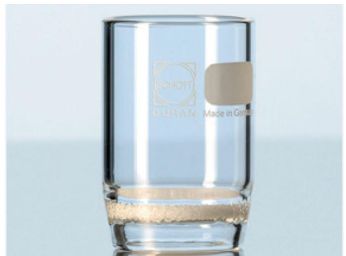
Abb. 2: Glasfiltertiegel von DURAN®
