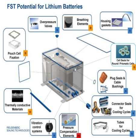
Abb. 1: Lithium-Ionen Batterie (Kritzer, Peter: Sealing Components for Batteries. Präsentation. Freudenberg Sealing Technology, ohne Jahr, S. 4)
