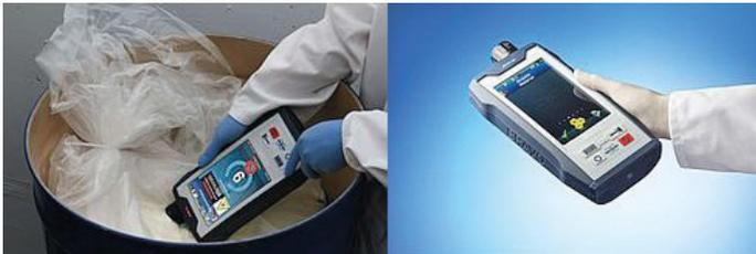
Abb. 1: Tragbares Raman-Spektrometer von Bruker (eigenes Foto)
