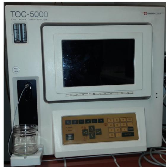
Abb. 2: Für die Analyse der Kohlenstoffbilanz der flüssigen Fraktionen verwendeter TOC-Analysator (eigenes Foto)
