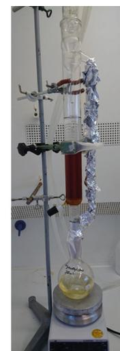
Abb. 2: Aufbau der Perforationsapparatur/ Flüssig-Flüssig-Extraktion (eigenes Foto)
