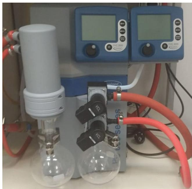
Abb. 2: Vakuumpumpe Vacuubrand PC 620 NT (eigenes Foto)
