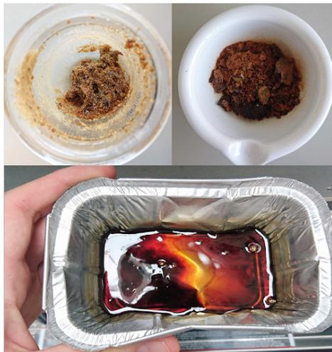
Abb. 1: Resultate nach der Trocknung von Dünnlauge mit verschiedenen Methoden (eigenes Foto)
