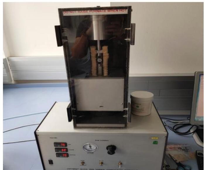
Abb. 2: Wärmeleitfähigkeitsmessgerät (eigenes Foto)
