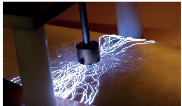
Abb. 2: Prüfung der Durchschlagfestigkeit (Foto: Isovolta AG)
